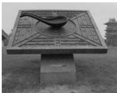
IV. ábra. Kínai iránytű – a kanál, amelyet általában mágnesvasércből faragnak, egy palából készült táblán fekszik
